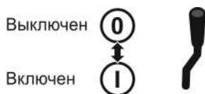
Рисунок 3.12. Схема управления ВОМ
