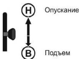
Рисунок 3.14. Схема управления навесным механизмом.
