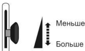
Рисунок 3.11. Рычаг регулировки подачи топлива («ручной газ»)
